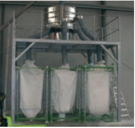
Tamizado para separación de carga en BIG BAGS con tamizadora FTI-1200 con tres separaciones en línea de PET reciclado con rendimiento superior a 2.000Kg/hora.
