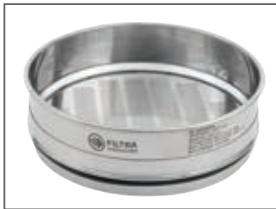
Tamiz de acero inoxidable con chapa perforada ovalado (ISO 5223).
