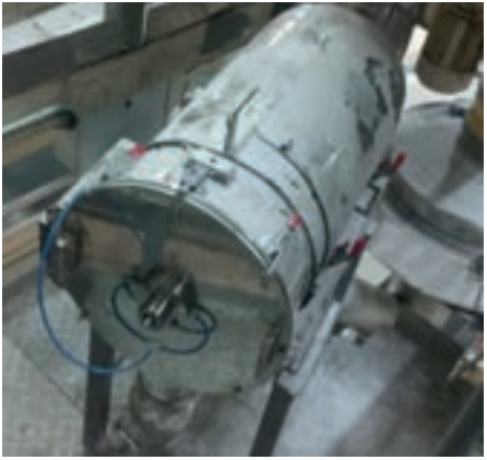
Ejemplo de tamizador centrifugo FTIC-0800 con malla de #300µ para tamizado de seguridad de mezcla de harinas en línea continua de ensacado.
