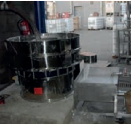
Ejemplo aplicación en FTI-1200 para productos viscosos (colas) para eliminar impurezas en línea de proceso.
