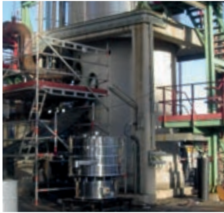
Tamizadora para separación granulométrica en planta química instalada en exterior para recuperación de materia prima. Tamizadora FTI-1500 con cuatro separaciones simultaneas.
