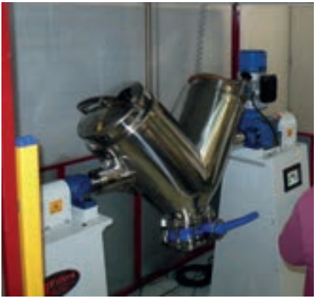
Mezcladora en UVE industrial FTIMV-100L , cuadro de maniobra integrado con autómata programable y pantalla táctil para acceder al menú de programas editables. Dispuesto de barreras ópticas de seguridad.
